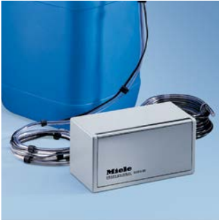
DOS G 60/1 Módulo da unidade doseadora Para PG 8535 • Para produtos de limpeza líquidos alcalinos, agentes desinfetantes quím. • Bomba doseadora com tubo flexível, ajustável através do comando electrónico da máquina • Lança de sucção curta (200 mm) para recipientes de 5 l incl. controlo do nível de enchimento do recipiente • Comprimento do tubo guia 1,90 m DOS G 60 Módulo da unidade doseadora • Igual a DOS G 60/1, mas com lança de sucção longa (300 mm) para recipientes de 5 e de 10 l
