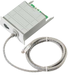
Módulo Ethernet XKM 3000 L Med • Módulo de comunicação para ligação ao Segosoft Miele Edition ou a um outro software de registo de processos • Buffer circular para um máx. de 30 protocolos de processos e 2 protocolos gráficos • Utilizável sem componentes adicionais para ligação directa ou à rede • Suporte do DHCP (Dynamic Host Configuration Protocol) para o ajuste automático dos parâmetros de rede • Preparado para a utilização de Remote Vision para uma comunicação automática em caso de erro • Velocidade de transferência 10/100 Mbit/s • Comprimento do cabo de ligação 1,5 m • Possibilidade de extensão do cabo • Opcional para os aparelhos PG 858X, PG 859X e PG 858X CD
