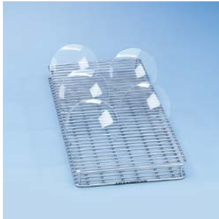
E 403, 1/2 Complemento • Para 105 vidros de relógio com 50-60 mm de diâmetro • 36 compartimentos, 9 mm de distância • A 35, L 200, P 445 mm
