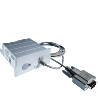
Módulo de série XKM RS232 10 Med • Módulo de comunicação para ligação ao dispositivo USB Segosoft Miele Edition ou a uma impressora de protocolos PRT 100 • Buffer circular para um máx. de 25 protocolos dos processos • Escolha entre protocolo curto e um longo para a adaptação do tamanho do protocolo às necessidades do cliente • Velocidade de transferência máx. 38 kbit/s • Comprimento do cabo de ligação 1,5 m • Possibilidade de prolongar o cabo até 15 m • Opcional para os aparelhos PG 858X, PG 859X e PG 858X CD
