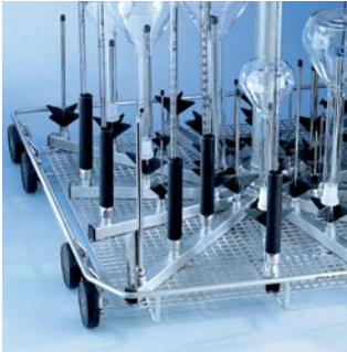
E 336 Casquilho • Em plástico, aparafusável • Para pipetas (comprimento máx. 445 mm) no carro injector • Ø 11 mm • Comprimento 121 mm
