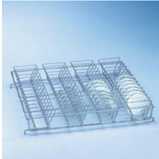
E 137, 1/1 Encaixe para E 136 • Para 56 caixas de Petri com 100 mm de diâmetro • 56 suportes, altura 70 mm • Distância aprox. 26 mm • A 95, L 485, P 445 mm
