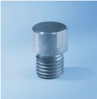
E 362 Parafuso cego • Rosca M 8 x 1, para bloquear os injectores que não estão em uso
