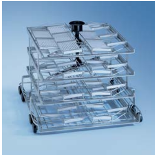
E 493 Carro • Compatível com PG 8536 • Para 8 complementos E 494 para placas de microtitulação em 4 níveis • O braço de lavagem inferior da máquina tem de ser substituído pela flange, fornecida com o conjunto, para um resultado de lavagem ideal • Dimensões de carga de baixo para cima: Nível 1: 70 mm Nível 2: 85 mm Nível 3: 85 mm Nível 4: 90 mm
