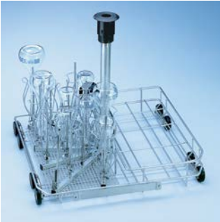
E 385, 1/2 Carro do injector TA • Para vidraria de colo estreito, com ligação para secagem por ar quente • 16 Injectores • Fixador para régua magnética ML/2 Do fornecimento fazem parte: • 7 x E 351 Injectores, Ø 4,0 x 160 mm • 7 x E 353 Suporte/fixador para injector, Ø 4,0 x 160 mm • 9 x E 352 Injector, Ø 6,0 x 220 mm • 9 x E 354 Suporte/fixador para injector, Ø 6,0 x 220 mm • 1 x Injector para doseador de pó
