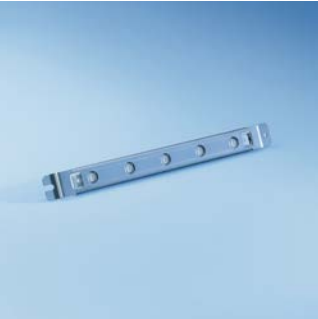
Régua magnética ML/2 • Régua magnética para reconhecimento automático do carro/ controle dos braços de lavagem por sensores • Pré-requisito para a utilização do braço de lavagem com íman para PG 8535/36 • 5 ímanes, de combinação variável • 15 combinações possíveis
