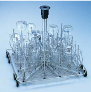
E 380, 1/1 Carro injector TA • Para vidraria de colo estreito, com ligação para secagem por ar quente • 32 injectores/ suportes/ fixadores Do fornecimento fazem parte: • 14 x E 351 Injectores, Ø 4,0 x 160 mm • 14 x E 353 Suporte/fixador para injector, Ø 4,0 x 160 mm • 18 x E 352 Injectores, Ø 6,0 x 220 mm • 18 x E 354 Suporte/fixador, Ø 6,0 x 220 mm • 1 x Injector para doseador de pó
