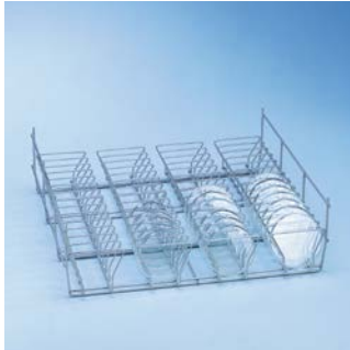
E 136, 1/1 Complemento • Para 56 caixas de Petri com 100 mm de diâmetro • 56 suportes, altura 70 mm • Distância aprox. 26 mm • A 145, L 485, P 445 mm
