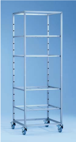
MT Mieltrans, carro de transporte • Para transporte e armazenamento de cestos e complementos • Dividido em 4 níveis, que são reguláveis a 102,5 mm • Deslocável com 4 rodas • Altura de carga: 549 x 599 mm • Dimensões: A 1985, L 616, P 662 mm
