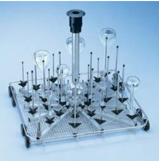
E 329, 1/1 Carro injector • Para vidraria de colo estreito • 39 Injectores Do fornecimento fazem parte: • 4/5 Injectores, Ø 2,5 x 90/110 mm • 5/5/5 Injectores, Ø 4,0 x 140/160/180 mm • 5/5/5 Injectores, Ø 6,0 x 200/220/240 mm • 1 x Injector para doseador de pó
