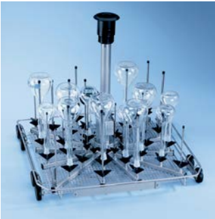
E 414, 1/1 Carro injector TA Igual a E 329, contudo com 37 injectores • Ligação para secagem por ar quente • Fixador para régua magnética ML/2 para reconhecimento automático do carro Do fornecimento fazem parte: • 4/3 Injectores, 2,5 x 90/110 mm de Ø • 5/5/5 Injectores, 4,0 x 140/160/180 mm de Ø • 5/5/5 Injectores, 6,0 x 200/220/240 mm de Ø • 1 x Injector para doseador de pó
